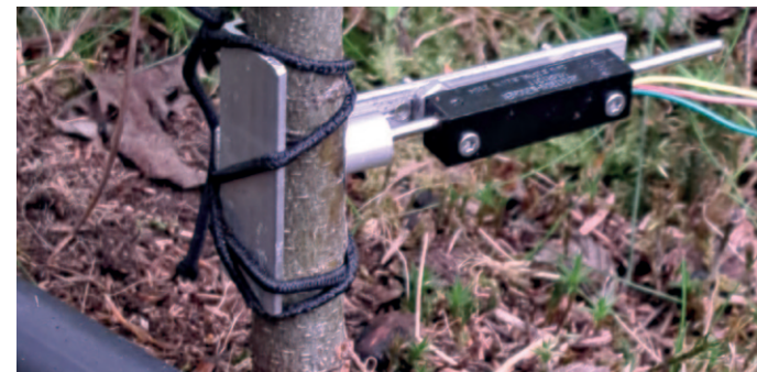
Hochaufgelöste Erkennung von Trockenstress eines Setzlings mittels Dendrometer (Stammdurchmesseränderung) und präzise Bewässerung über Knopftropfer.
