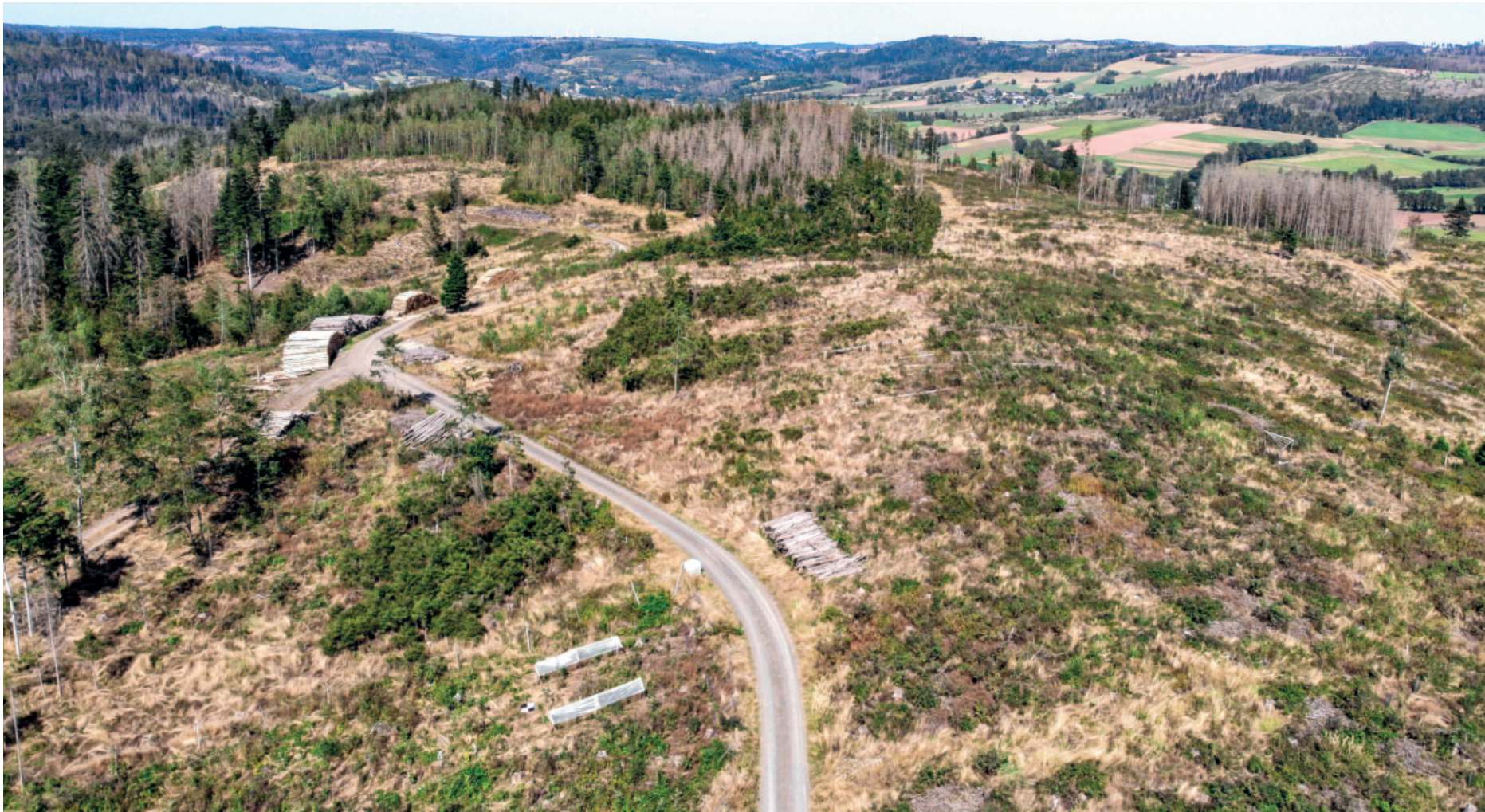
Bildvordergrund: Aufgeforstete Kalamitätsfläche im Frankenwald mit temporären Regendächern zur experimentellen Steigerung der Bodentrockenheit und Herbeiführen einer Bewässerungsbedürftigkeit.
